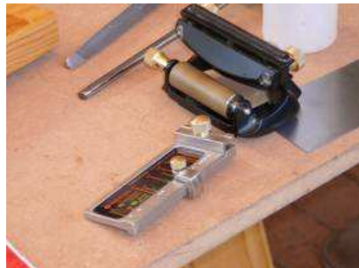
Die setmate om die finale vlak mee te slyp
